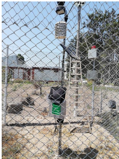
Foto 2 Estación ClimateMinder (RainBird) para el monitoreo de variables meteorológicas y humedad del suelo instalado en una parcela de investigación en la UNALM
