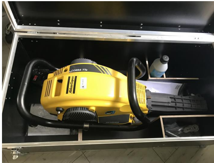
Figura 4. Vibracore para la extracción de núcleos de sedimentos y núcleos de suelos.
