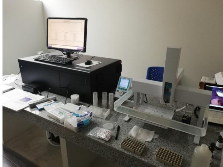
Foto 1 Analizador isotópico laser 18O y 2H para agua líquida – Laboratorio de Recursos Hídricos de la UNALM.
